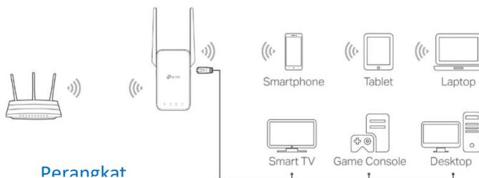
Gambar 4.10 Contoh Topologi Jaringan Menggunakan *Repeater*
