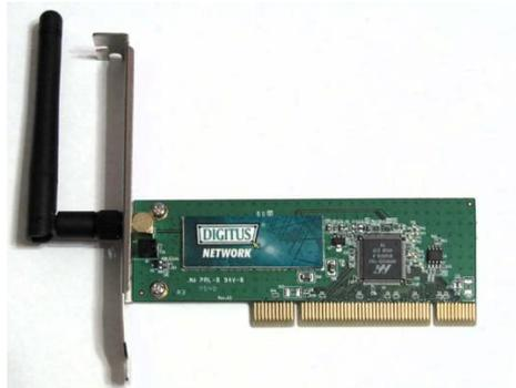
Gambar 4.4 Kartu Jaringan Nirkabel Internal Untuk PC
