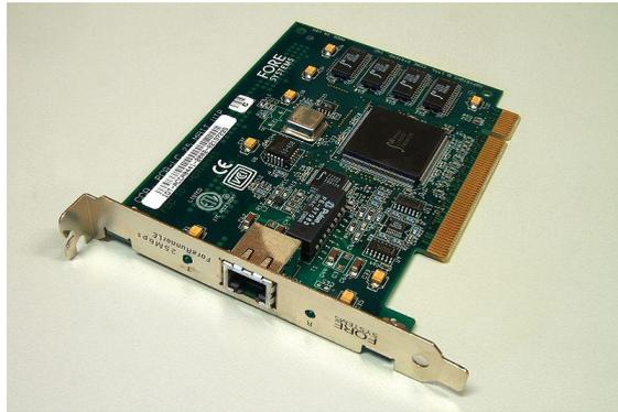
Gambar 4.1 Kartu Jaringan Internal Untuk Kabel
